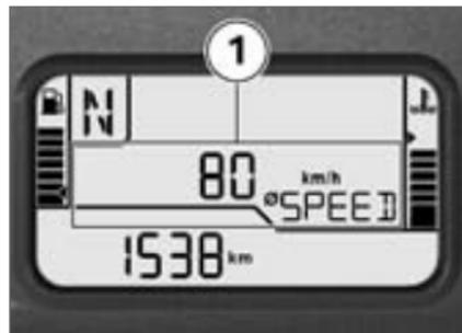
Bei der Berechnung der Durchschnittsgeschwindigkeit **1** wird die seit dem letzten Zurücksetzen verstrichene Zeit zugrunde gelegt. Nicht berücksichtigt werden Fahrtunterbrechungen, bei denen der Motor abgestellt wurde.
