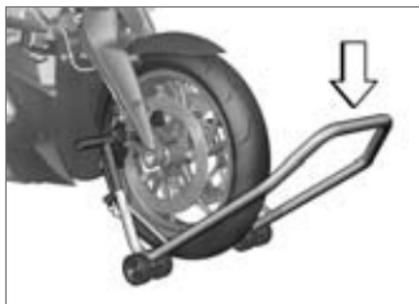
**!** Steht das Motorrad auf dem Kippständer: Wird das Motorrad vorn zu weit angehoben, hebt der Kippständer vom Boden ab und das Motorrad kann zur Seite kippen.
