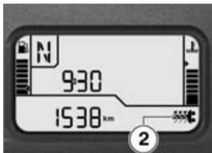
Die Lenkergriffe können in zwei Stufen beheizt werden. Die zweite Stufe **2** dient zum schnellen Aufheizen der Griffe, anschließend sollte auf die erste Stufe zurückgeschaltet werden.
