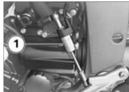
Der Sensor **1** im Schaltgestänge erkennt den Schaltwunsch und leitet die Schaltunterstützung ein.
