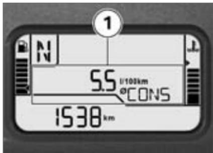
Bei der Berechnung des Durchschnittsverbrauchs **1** wird die seit dem letzten Zurücksetzen verbrauchte Kraftstoffmenge mit den seitdem gefahrenen Kilometern verrechnet.
