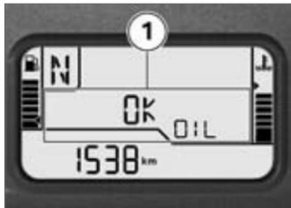
Der Ölstandshinweis **1** gibt Auskunft über den Ölstand im Motor. Er kann nur bei Fahrzeugstillstand aufgerufen werden.
