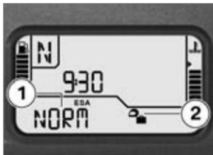
Der gewählte Fahrmodus wird im Multifunktionsdisplay im Bereich **1** angezeigt, der Beladungszustand im Bereich **2**.
