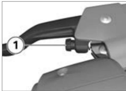
• Einstellschraube **1** im Uhrzeigersinn drehen, um den Ab-
