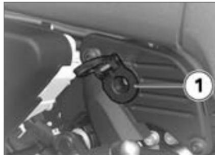
Bei zu niedriger Batteriespannung und bei Überschreitung der maximalen Belastbarkeit der Steckdose **1** wird diese automatisch abgeschaltet.
