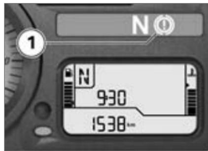
ABS-Warnungen werden durch die ABS-Warnleuchte **1** angezeigt.
