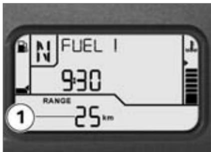
Die Restreichweite **1** gibt an, welche Strecke mit dem verbleibenden Kraftstoff noch gefahren werden kann. Sie wird nur nach Erreichen der Kraftstoffreserve angezeigt. Die Berechnung erfolgt anhand des Durchschnittsverbrauchs und des Kraftstofffüllstands.
