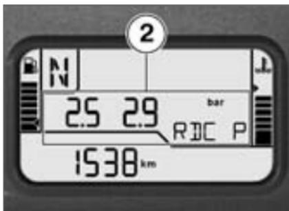
Die angezeigten Reifenfülldrücke **2** beziehen sich auf eine Reifentemperatur von 20 °C. Der linke Wert stellt
