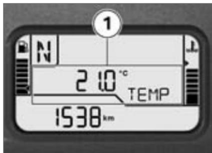
Bei stehendem Fahrzeug kann die Motorwärme die Messung der Umgebungstemperatur **1** verfälschen. Wird der Einfluss der Motorwärme zu groß, wird vorübergehend -- angezeigt.
