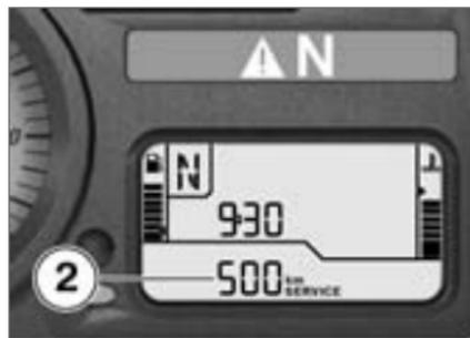
Bei hohen Jahreskilometerleistungen kann es unter Umständen vorkommen, dass ein vorgezogener Service fällig wird. Liegt der Kilometerstand für den vorgezogenen Service innerhalb von 1000 km, werden die verbleibenden Kilometer **2** in 100-km-Schritten heruntergezählt und
