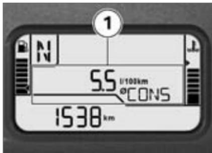
Bei der Berechnung des Durchschnittsverbrauchs **1** wird die seit dem letzten Zurücksetzen verbrauchte Kraftstoffmenge mit den seitdem gefahrenen Kilometern verrechnet.
