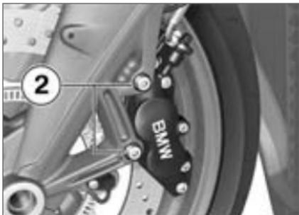
**!** Im ausgebauten Zustand können die Bremsbeläge so weit zusammengedrückt werden, dass sie sich beim Einbau nicht mehr auf die Bremsscheibe aufstecken lassen.
