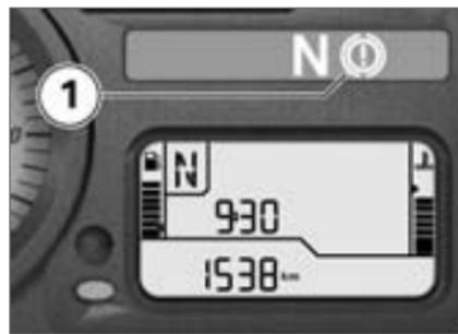
ABS-Warnungen werden durch die ABS-Warnleuchte **1** angezeigt.
