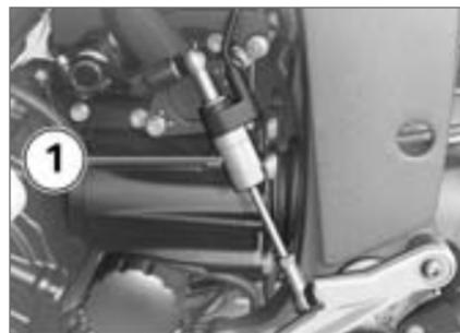
Der Sensor **1** im Schaltgestänge erkennt den Schaltwunsch und leitet die Schaltunterstützung ein.
